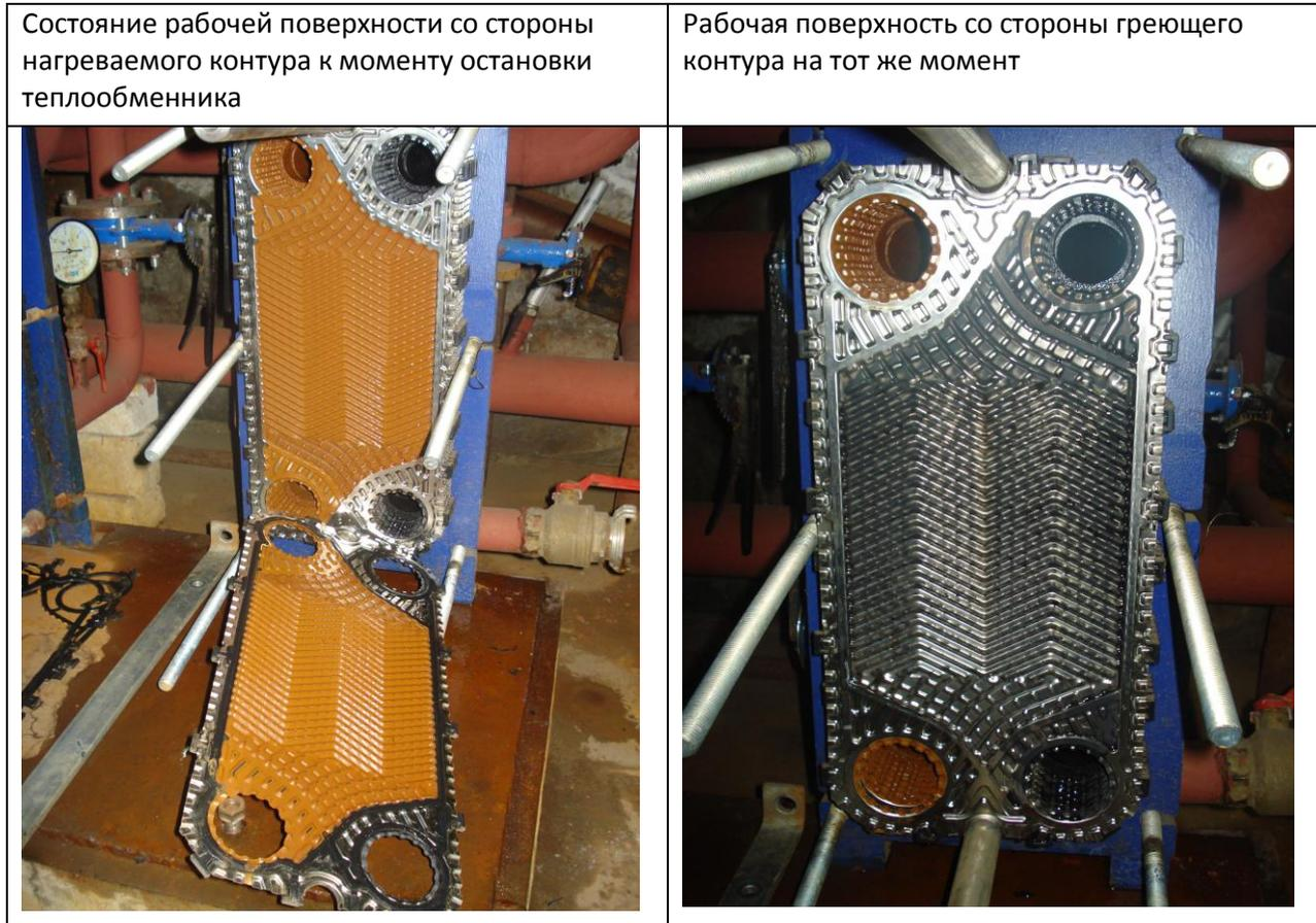
Запуск системы обезжелезивания в постоянную эксплуатацию обеспечил безостановочную работу теплообменного агрегата до 5 – 6 недель.
