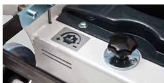
Регулируемое давление шлифовального круга
