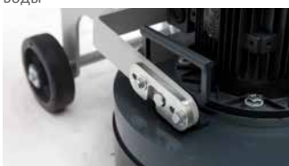
DIF – плавающая подвеска инструмента
