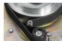
Поли-V – ременная передача
