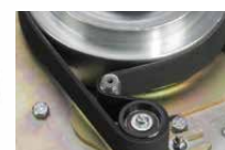
Поли-V – ременная передача
