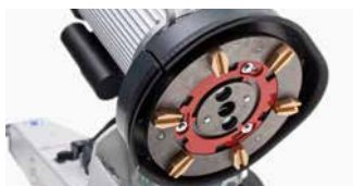
Унифицированная система расходного инструмента, подходящая для всех моделей
