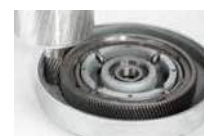
Металлические зубчатые шестерни привода
