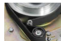
Поли-V – ременная передача
