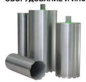
Алмазный инструмент для сверления (бурения) – буровая коронка – представляет собой стальной цилиндр («стакан») с напаянными или наваренными алмазными режущими сегментами.
