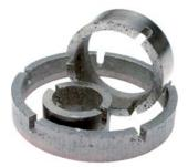
Для малых диаметров (до Ø40 мм) иногда более технологичной оказывается замена алмазных режущих сегментов цельными режущими кольцами. Коронки с цельными алмазными кольцами отличаются особенно высокой проходкой (ресурсом).
