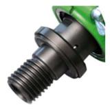
Для крепления алмазной буровой коронки к шпинделю бормотора (специальной дрели для алмазного сверления) существуют несколько различных стандартов хвостовиков. Фирма Dr.Schulze GmbH (Германия) использует резьбовые соединения самых распространенных стандартов. Хвостовик буровых коронок до Ø50 мм имеет наружную резьбу 1/2", от Ø50 мм и выше — внутреннюю резьбу 1 1/4". Поэтому шпиндель бормоторов небольшой мощности — комбинированный, с внутренней резьбой 1/2" и наружной резьбой 1 1/4".
