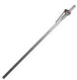
Другой способ фиксации станины — с помощью распорного крепежного устройства. Длина устройства регулируется в диапазоне 1700-3150 мм. Устройство следует упереть в платформу станины или, если позволяет конструкция станины, вставить устройство в колонну станины, затем отрегулировать длину устройства до упора в потолок, затем поворотом рычага жестко расклинить устройство между станиной и потолком.
