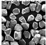
Для производства режущей части алмазного инструмента используют алмазную крошку размером 150-500 микрон:
