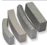
Алмазная крошка смешивается с металлическим порошком. Полученная масса специальными прессами формуется в изделия (алмазные сегменты) различной формы в зависимости от назначения – для алмазных буровых коронок, для алмазных отрезных дисков или фрез, для шлифовальных дисков или пр.
