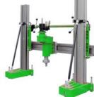
Для сверления алмазными буровыми коронками диаметром выше 500 мм обычно используют гидравлический бормотор, который устанавливается на мощную станину. Гидравлический бормотор — небольшой и легкий. А громоздкий и тяжелый электрогидравлический агрегат, обеспечивающий необходимое давление и расход масла для бормотора, располагается на земле вблизи такой установки алмазного сверления.
