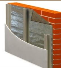
Утепление внешних стен с последующей отделкой сайдингом, шифером и т.п.
