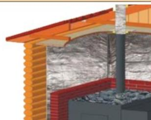
Теплоизоляция и защита от возгорания крыши и чердачных перекрытий в местах прохождения дымоходов.
