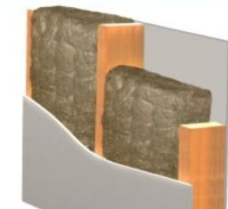
Утепление и звукоизоляция внешних стен с вентилируемым воздушным зазором.
