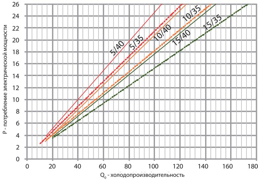
Потребление электрической мощности в функции получаемой холодопроизводительности для разных показателей температур испарения и конденсации.
