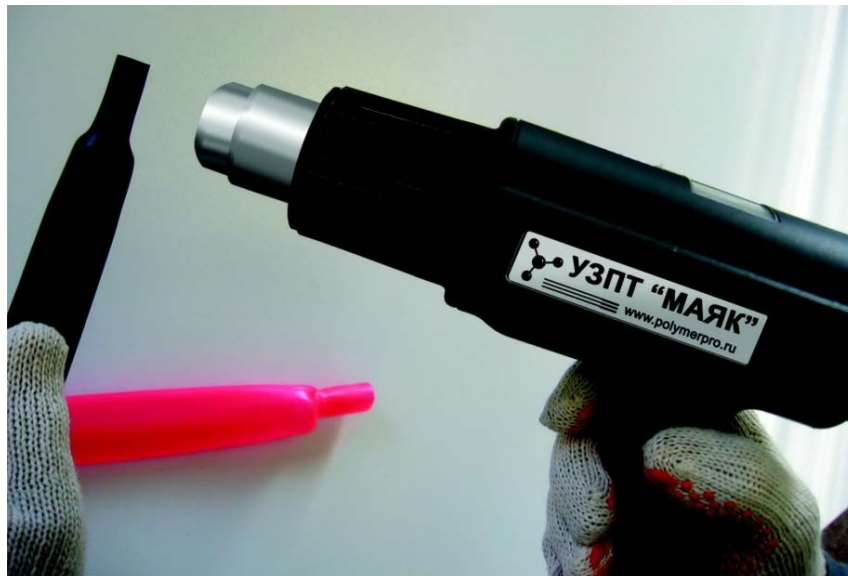
Рисунок 1 – Процесс термоусадки ТППнг
