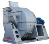
Дымососы-пылеуловители ДП-10 и ДП-12 предназначены для транспортирования и очистки от пыли технологических газов, транспортирования и очистки от золы и недожога дымовых газов малых котельных, работающих на твердом топливе. Могут применяться для транспортирования и очистки газов от пыли, с размером частиц более 20 мкм, из сушильных барабанов асфальтобетонных заводов, аспирационного воздуха в литейных цехах и других производствах при температуре газов до 200°С и запыленностью до 50 г/м3.
