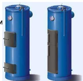
Котлы - свечки КВр предназначены для обогрева различных помещений, оснащенных системой отопления. Длительность горения достигается за счет способа горения (сверху-вниз) и большого загрузочного проема. В среднем составляет 16-24 часов. Котлы имеют КПД - 85%
