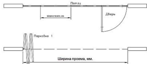
**Несимметричная перегородка.** Мах. высота – 2500мм., Мах. ширина – 4200мм., Мах. ширина панели – 700мм., вес 25-35 кг./м.кв., стекло 10-12мм.
