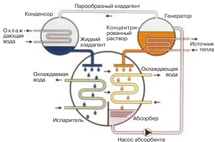
Рисунок 1. Упрощенный цикл абсорбционного охлаждения
