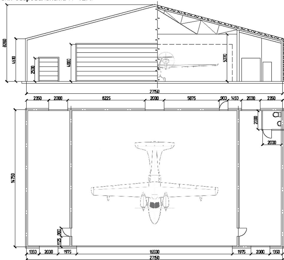
Проект авиационного ангара размерами 18x21x4м (378 м2) под ограждающие конструкции (тентовая ткань ПВХ, профилированный лист, сэндвич панели).
